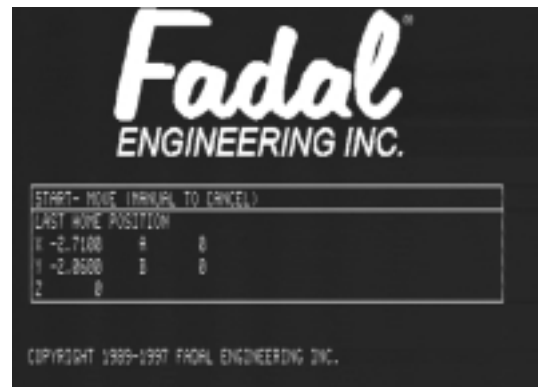
Figura S: 1-8 Pantalla de mover (manual para cancelar)(cero)
