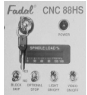
Figura S: 2-3 LLAVE DE BLOQUEO como protección para la edición no autorizada de programas.
