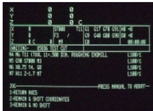
Figura S: 4-1 El control en el modo de espera.
