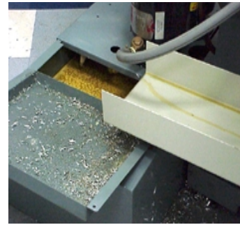
Figura S: 1-3 Nivel de llenado del depósito de refrigerante.
