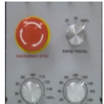
Figura S: 5-1 Botón de parada de emergencia.
